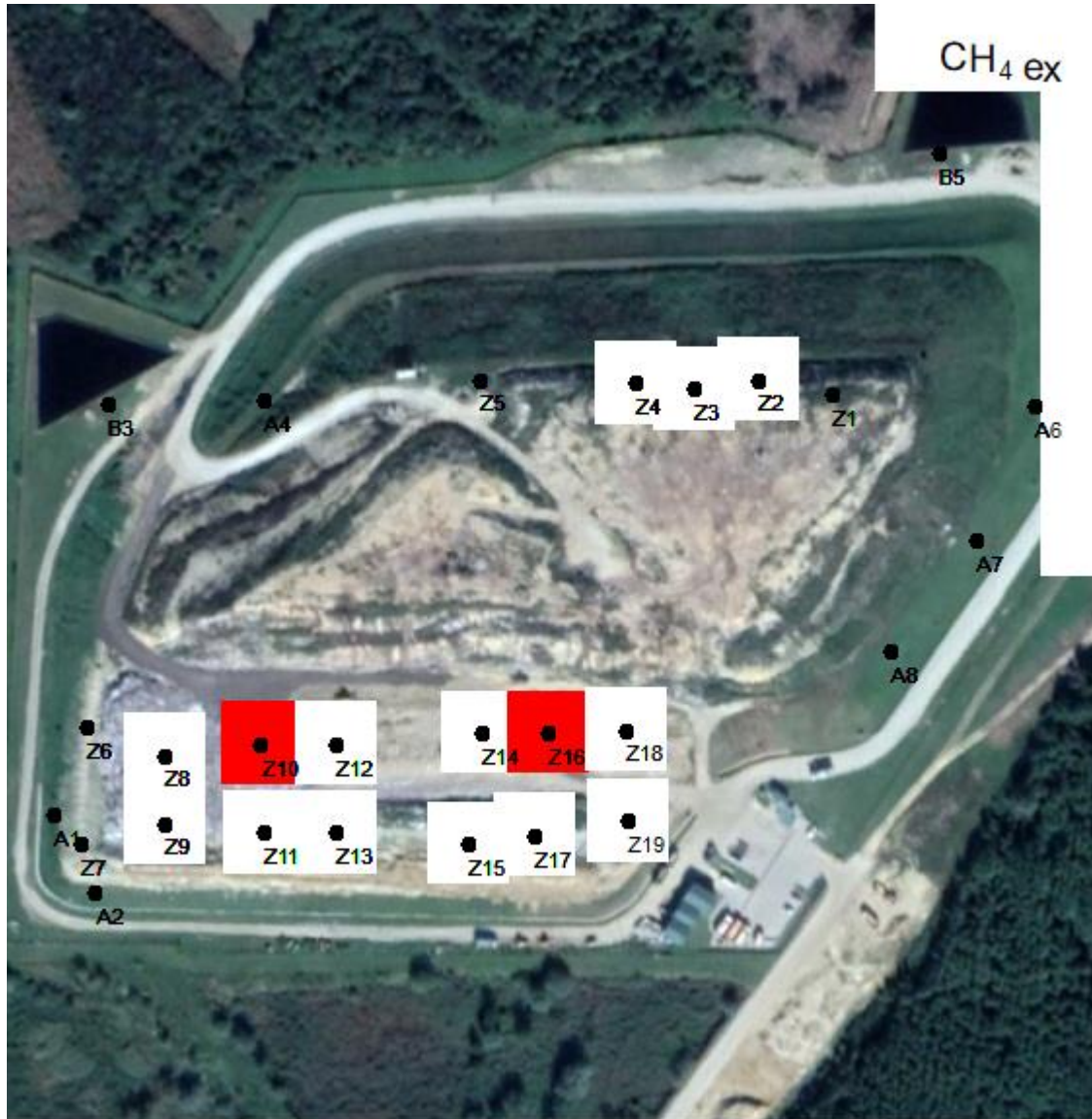
Slika 6: Odzračnici na kojima postoji opasnost od eksplozije zbog eksplozivne koncentracije CH 4 (5 – 15 vol %) na odlagalištu Piškornica - Koprivnicki Ivanec.
