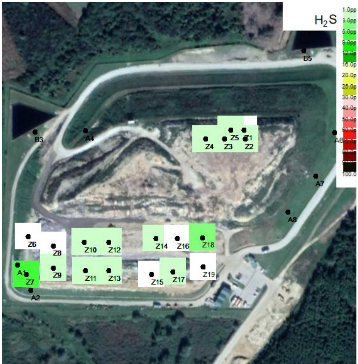
Slika 5: Koncentracije H 2 S u ppm po odzračnicima na odlagalištu Piškornica - Koprivnički Ivanec.
