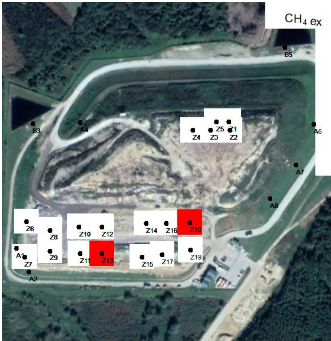
Slika 6: Odzračnici na kojima postoji opasnost od eksplozije zbog eksplozivne koncentracije CH 4 (5 – 15 vol %) na odlagalištu Piškornica - Koprivnički Ivanec.
